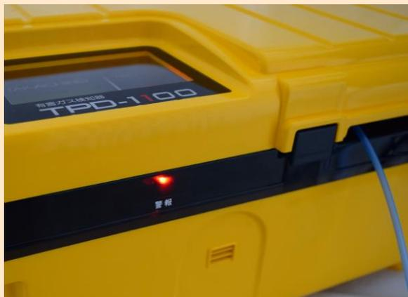
本体外枠に搭載した2つのLEDランプが警報時に交互に点滅し周囲へ異常を伝えます。
