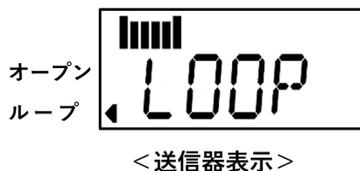
※電磁法では送信器から交流電流を流すため、静電法に比べ機器の消費電流が増加します。長時間使用する場合は、ACアダプタの使用を推奨します。
