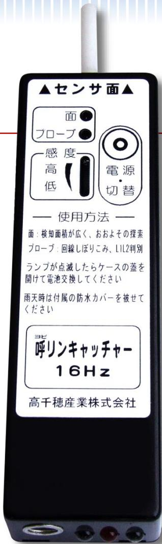
16Hz方式は、携帯電話にてお客様電番を発信し、目的の引込線に近づける事で交換機からの16Hzベル信号を捕捉し、LED点滅により目視確認する電番確認ツールです。
