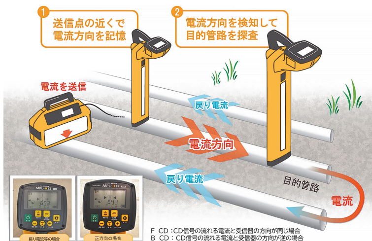
図-3 CD法（電流方向測定）の概要
